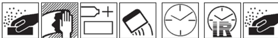
отшлифовать    обезжирить    время нанесения 3-5 мин/20°C    наносить шпателем    20-30 мин/23°C    5-8 мин    P80-P120
